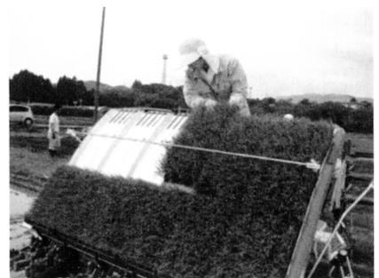
写真3. 2週間苗の田植機への搭載状況
